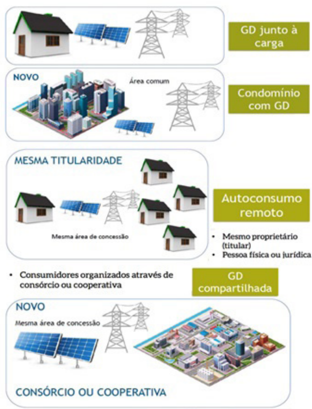
Figura 34. Sistemas fotovoltaicos de micro e minigeração distribuída – possibilidades com a A REN 687
