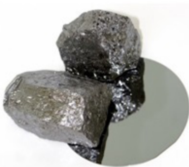
Figura 4. Amostra de silício grau metalúrgico e lâmina de silício grau solar
