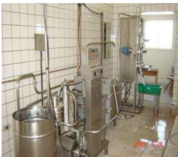
Figura 2 - Mini-usina de beneficiamento de leite Fonte: (FEI, [200-?])
