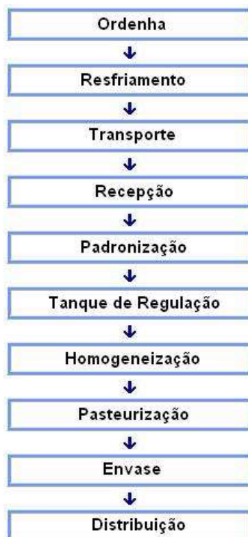
Figura 1 - Processo simplificado para produção de leite Fonte: adaptado de (RÉVILLION, [200-?])
