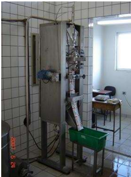
Figura 11 - Sistema de envase utilizando embalagens plásticas Fonte: (FEI, [200-?])
