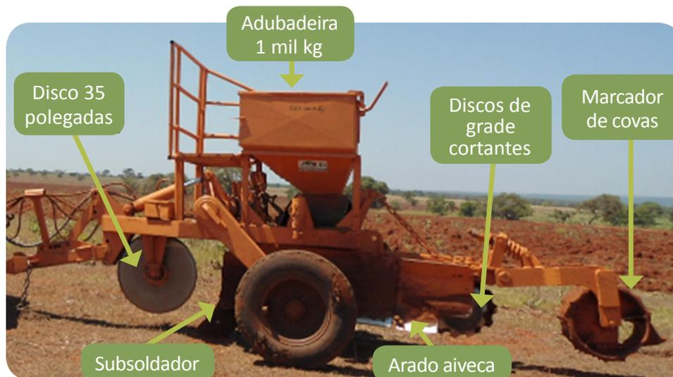
**Figura 16.** Equipamento subsolador JHP com adubação e marcação de covas
