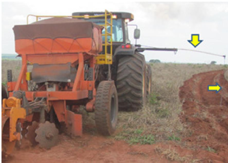
**Figura 20.** Detalhe do “bigode”, varão e corrente na ponta
