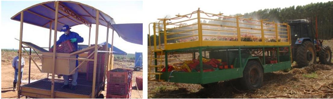
**Figura 24.** Imersão de mudas em cupinícida e carreta para transporte de mudas com irrigação
